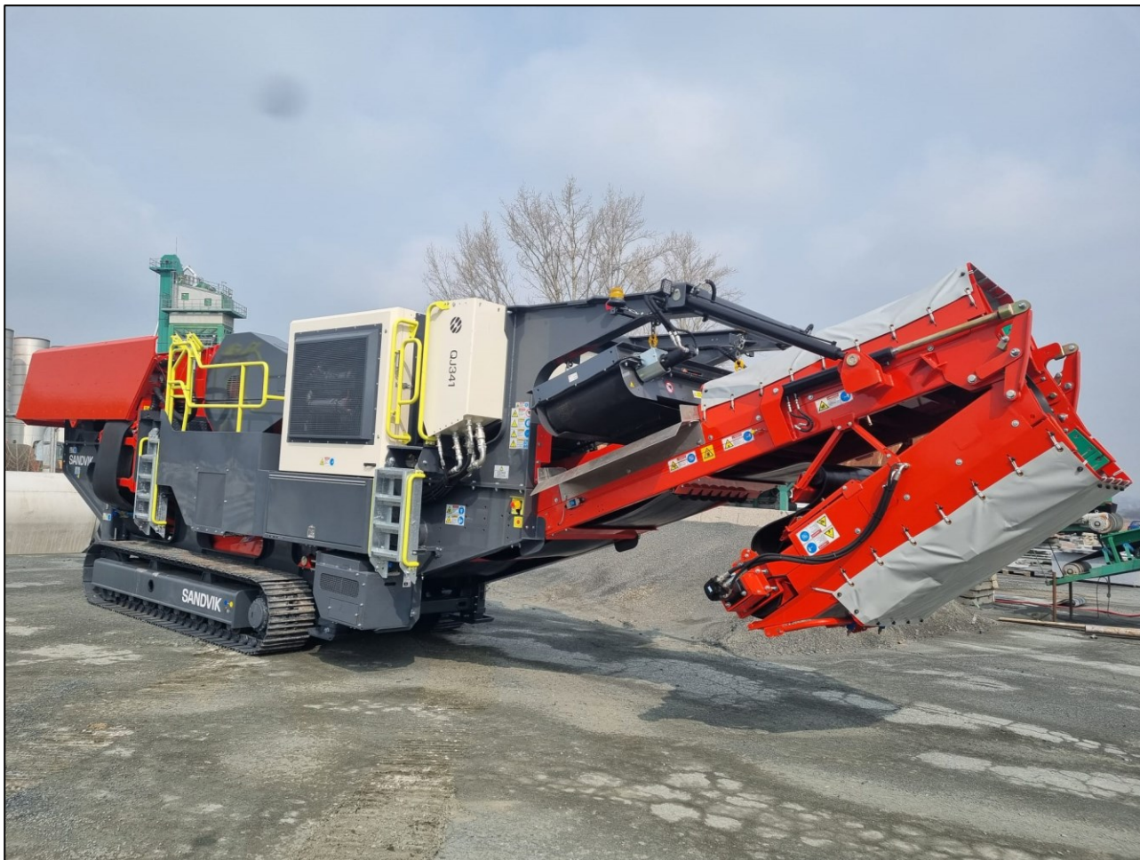
Obrázek č. 5: Mobilní čelistový drtič Sandvik QJ341
